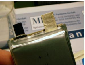
... und zwar hier: Um Kurzschlüsse zu vermeiden wird die nicht genutzte Lötfahne abgeklebt.
