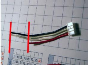
Hier sollte man jedes zweite Kabel so ablängen, dass es dem Abstand der Lötfahnen entspricht.
