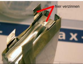
Die Lötfahnen so ablängen, dass sie leicht übereinander passen und nicht überstehen.
