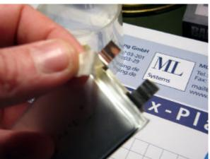
Der obere Klebestreifen wird abgezogen, der untere jedoch belassen – das ist die Zugentlastung für die Lötfahne
