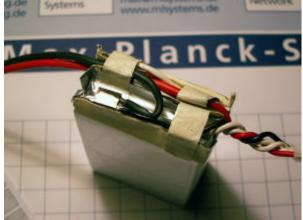
Ob man die Kabel zur gleichen Seite herrausschauen lässt wie die Balancer-Anschlüsse, ist Geschmacksache. Ich führe die Kabel möglichst unter den Lötkontakten durch.
