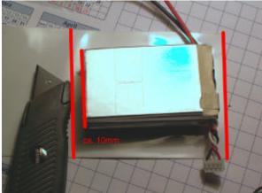
Schrumpfschlauch: Dieser sollte so gerade eben über den Akkupack passen und an beiden Enden etwa 1-2cm überstehen.
